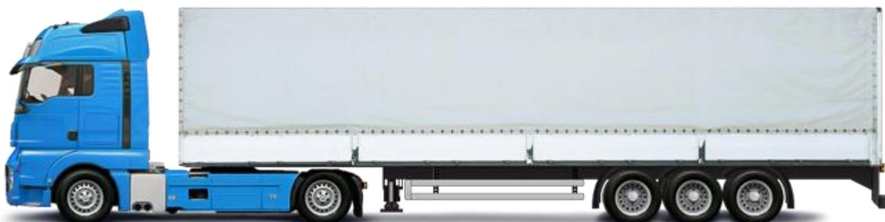
«Евротент» — условное понятие обозначающее грузовой автомобиль с полуприцепом имеющим габаритные размеры, близкие к указанным характеристикам. В фуру, как иначе называют евротент, вмещается по ширине поставленные поперек 2 европоддона длиной 120 см каждый.
