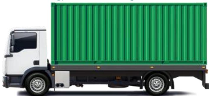
По потребительским качествам автомобиль с установленным 20 футовым морским контейнером близок к 10 тонному автомобилю с тентованным или изотермическим кузовом.
